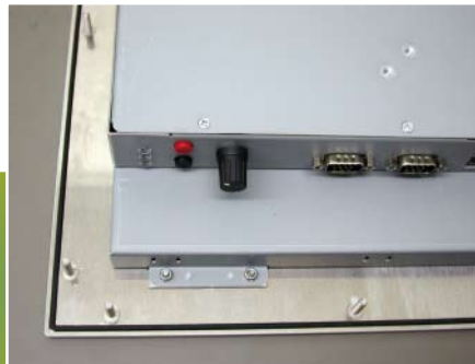
Die IPC vom Typ Slimline sind mit einer Schutzglasscheibe und einer Gummidichtung versehen und erfüllen damit an der Front IP65 (Foto: TL Electronic)
