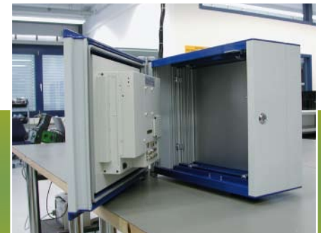
Um den IP65-Schutz zu garantieren, wird der IPC in eine Bedienkonsole eingebaut.
