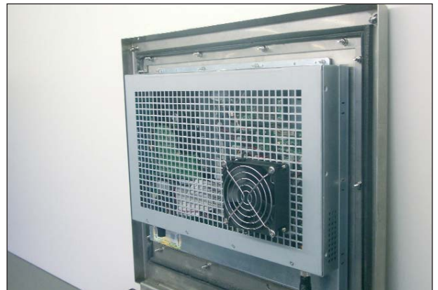
Auch bei einem lüfterlosen Industrie-PC kann die Einbau-Situation – hier ein IP65-dichtes Gehäuse – einen zusätzlichen Lüfter erfordern.
