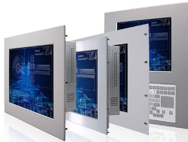
-PMA ... -PME -19 -BF Panelmount ... / 10 mm Panelmount 19-Zoll-Rackmt. Bedienfront 5 mm Aluminium / black 5 mm Edelstahl 3 mm Stahl 5 mm Aluminium RAL 7035 gebürstet RAL 7035 RAL 7035 inkl. Schutzglas ... inkl. Schutzglas inkl. Schutzglas inkl. Schutzglas IP65 ... IP65 IP65 IP65 (≥ WM 12) (WM 10) (≥ WM 15) (≥ WM 12) (≥ WM 15)
